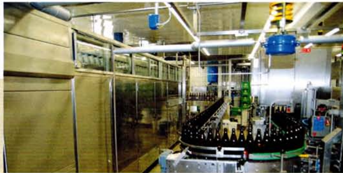
Der Schweizer Spezialist lieferte nicht nur die Flaschenreinigungsmaschine, sondern auch die Flaschen- und Kasten-Transportbänder durch die Linie
