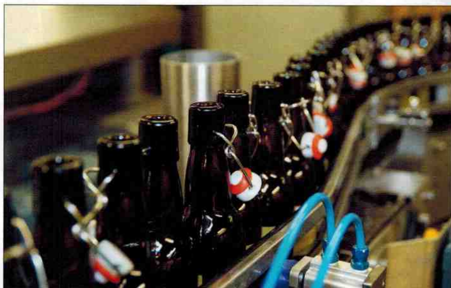
1800 Flaschen in der Stunde kann nur einen Meter breite und fünf Meter lange Flaschen-Reinigungsmaschine vom Typ „CB4-0,5-R-4,8BVng“ in der Stunde reinigen. Ideale Maschine für kleine und mittlere Betriebe!
