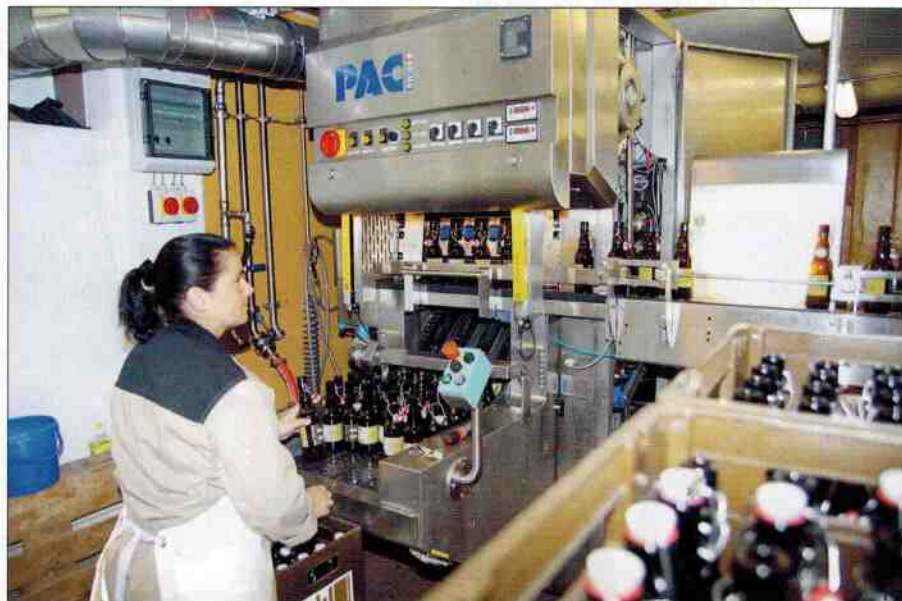
Von Hand werden die Mehrwegflaschen in Viererreihen auf das Band zur Flaschenwaschmaschine von PAC Global gesetzt. Nach acht Minuten verlassen sie perfekt gereinigt in Richtung Füllmaschine. (Fotos: broesele)
