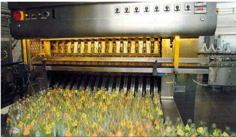
Die neue PAC Global-Flaschenreinigungsmaschine vom Typ „CB 15-0,5-RV8,2ng“ ist 8,2 Meter lang und nur 1,7 Meter breit. Zeitgleich sind immer 2205 Flaschen in der Maschine, jede Stunde können also bis zu 11 000 gereinigt werden.
