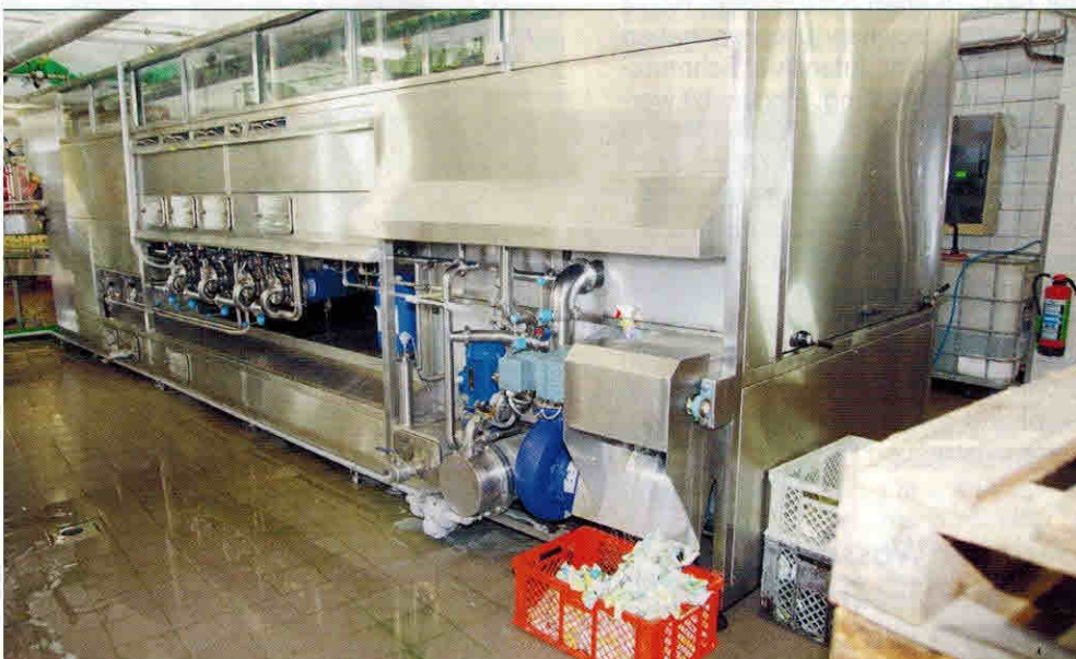
Scherben und Etikettenreste werden sauber ausgetragen, die Maschinen-Längsseiten weisen große Sichtfenster zur Kontrolle auf, alle Bereiche sind sehr gut zugänglich zur Reinigung.
